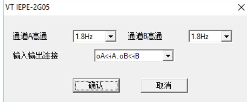
若高通滤波器设置为“无”，则输入端由于 AC 耦合而仍然具有 0.03Hz 的高通滤波。对于量程 $\pm 250\text{mV}$ 、 $\pm 500\text{mV}$ 、 $\pm 1\text{V}$ ，建议采用 1.8Hz 或以上的高通滤波设置。
