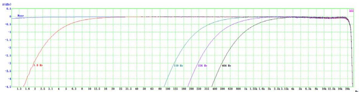
内部高通滤波器的频率响应 (采样频率 48kHz)
