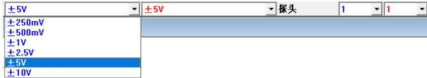
在通常情形下（即：IEPE 传感器没有外部衰减开关），必须将“探头”开关挡位置于“1”。
