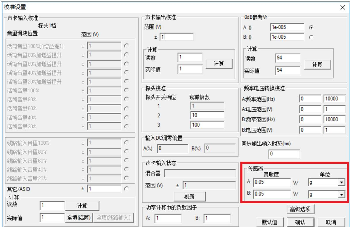
注意：在以上的对话框中，声卡输入校准栏中的“范围（V）”一系列的数值不会影响 VTIEPE-2G05 的测量数值。
