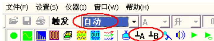
将示波器两通道的探头尖端与探头地相连，并将触发模式置于“自动”档（参见上图），在示波器窗口中您应当看到一条位于 0V 的水平线。否则，在示波器运行时，您可以点击工具条上的“1A”和“1B”按钮，并选择“Yes”来通过软件补偿将两通道调零。您可能需要在每次改变采样参数后，重复此调零操作。
