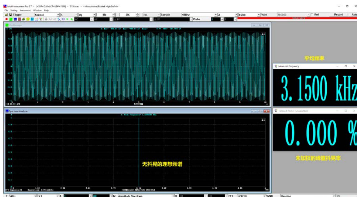
图 4. 理想情况下的 3159Hz 正弦信号的频谱和峰值抖晃率
