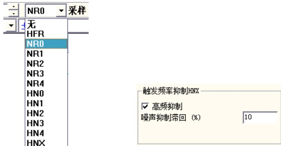
触发频率抑制可以用来滤掉触发信号中的噪音以避免误触发。可选项有：无（全通）、HFR（高频抑制）、NR0~NR4（噪声抑制）、HN0~HNX（高频抑制+噪声抑制）。噪声抑制有多个等级。通常 0~4 级的噪声抑制滞回是固定的，而 X 级的噪声抑制滞回可由用户通过[设置]>[模数转换设备]>“触发频率抑制 HNX”来设定。对于 HNX 级，您可以指定是否需要引入高频抑制以及噪声抑制滞回的数值（以百分比表示）。其它选项的详情请参考下一章“硬件指标”。
