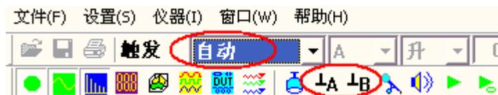
将示波器两通道的探头尖端与探头地相连, 并将触发模式置于“自动”档(参见上图), 在示波器窗口中您应当看到一条位于 0V 的水平线。否则, 在示波器运行时, 您可以点击工具条上的“1A”和“1B”按钮, 并选择“Yes”来通过软件补偿将两通道调零。您可能需要在每次改变采样参数后, 重复此调零操作。若您选择了“No”, 则软件调零补偿将不起作用。
