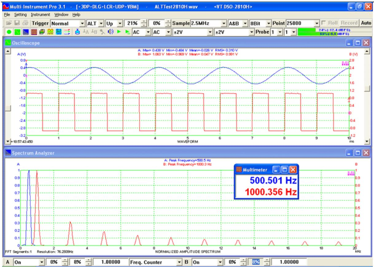
下图是一幅混合信号显示图，其中 A 通道和 B 通道输入模拟信号，EXT 通道输入数字信号。
