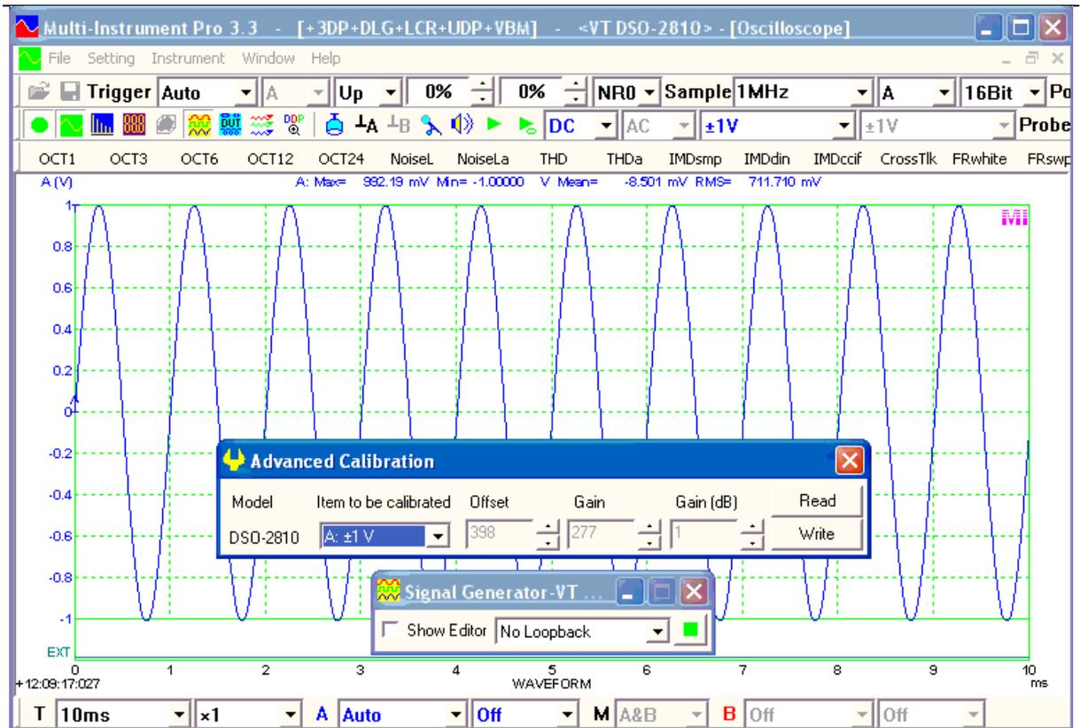
您可以校准在每个量程下的每通道的直流偏置和增益。以下是在 $\pm 1\text{V}$  量程下校准 A 通道的步骤:
