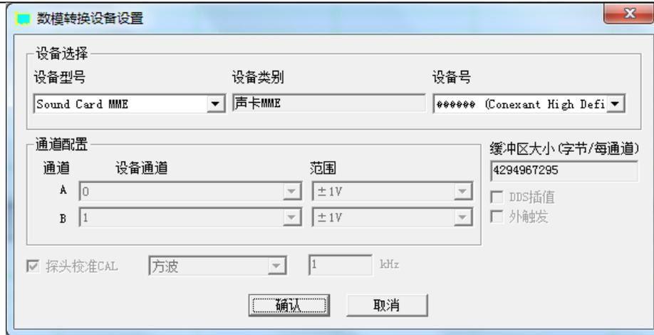
您可以选择输出方波或 MLS 信号。当选择输出 MLS 信号时，这里的频率指的是 MLS 发生器的时钟频率而不是输出信号的频率。通常探头校准信号输出处于激活状态。您可以通过取消“探头校准 CAL”检查框的选择来禁止探头校准信号的输出。这可以提高示波器的信噪比，尤其在量程低于 100mV 时效果明显。
