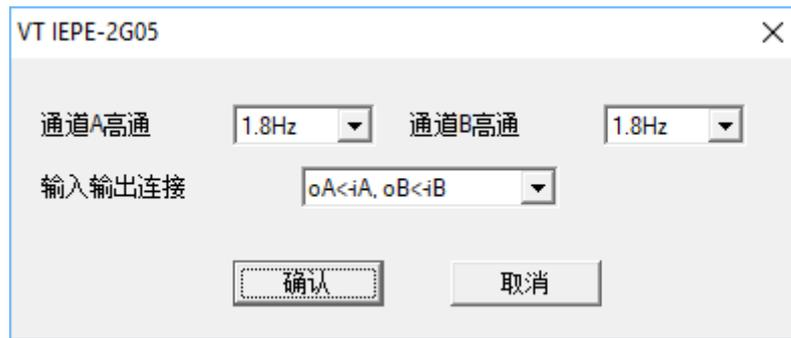
若高通滤波器设置为“无”，则输入端由于 AC 耦合而仍然具有 0.03Hz 的高通滤波。对于三个低量程挡位：例如 VT IEPE-2G05 的  $\pm 250\text{mV}$ 、 $\pm 500\text{mV}$ 、 $\pm 1\text{V}$ ，建议采用 1.8Hz 或以上的高通滤波设置，以去除任何可观察到的 DC 偏置。
